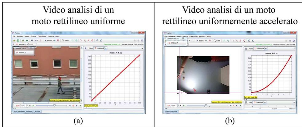
Figura 3. Interfaccia del software di video analisi Tracker, usato per analizzare i moti rettilinei uniforme di un pedone (a) e uniformemente accelerato di un oggetto in caduta libera (b).
