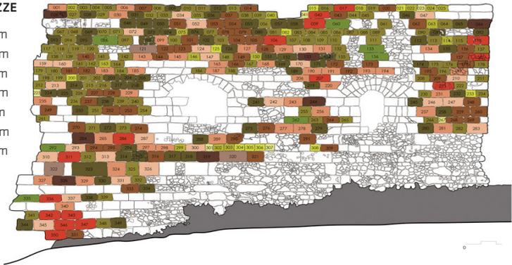
Fig. 2.6 Cagliari, forte di Sant'Ignazio. Analisi del prospetto della casamatta di ponente: Analisi delle tipologie murarie e dei caratteri dimensionali (rilievo D.R. Fiorino e C. Giannattasio, restituzione grafica M. Belfiori).
