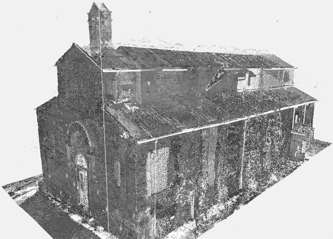
sciuti, ne tantomeno protocolli per la certificazione del livello di affidabilità del rilievo. A questa tecnologia è stato affiancato il rilievo fotogrammetrico 2D, con il quale è stata affrontata la realizzazione degli ortofotopiani dei fronti interni ed esterni.
