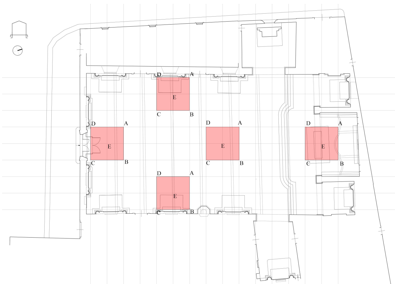
Fig. 10 Griglia per la campagna di misure in loco. Individuazione delle 5 zone più significative. Pianta realizzata dagli autori.
