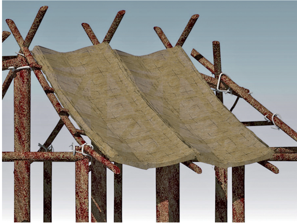
Fig. 5 Ipotesi ricostruttiva della carpenteria di un tetto di una capanna. La possibile deformazione dell'orditura minuta e del manto di copertura genera l'emergere dei falsi puntoni.
