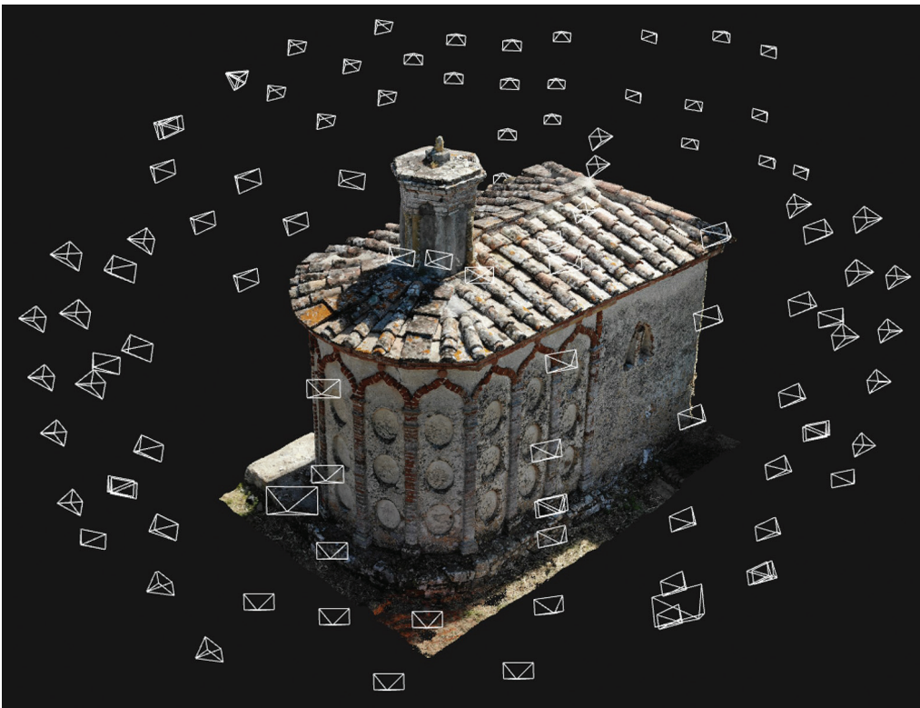
Fig. 17 Modello 3D generato mediante metodologia fotogrammetrica SfM sulla base delle riprese fotografiche a terra e in quota. (Elaborazione grafica: Lumini A., 2020)
