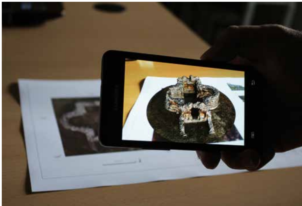
Fig.8 Ejecución de la aplicación de Realidad Aumentada generada con el modelo 3D sobre la imagen en planta de la representación cartográfica
