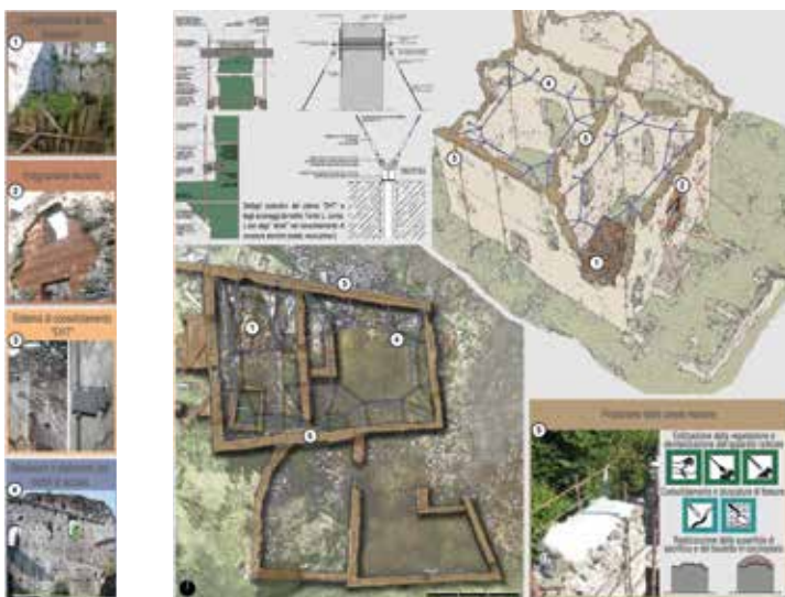
Fig.3c Tavola riassuntiva degli interventi sulla struttura tramite rappresentazione grafica tridimensionale
