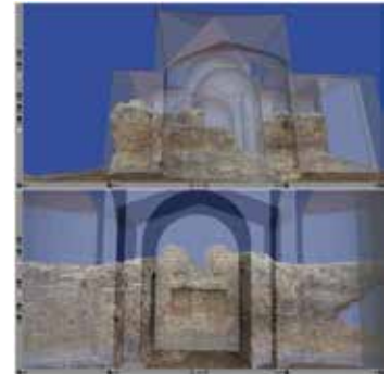
Fig. 6 Vista de la nube de puntos conjuntamente con el modelo volumétrico vectorial de las principales aristas (líneas negras). Los puntos del primer plano se aprecian separados mientras que los de la pared posterior dan la impresión de continuidad
