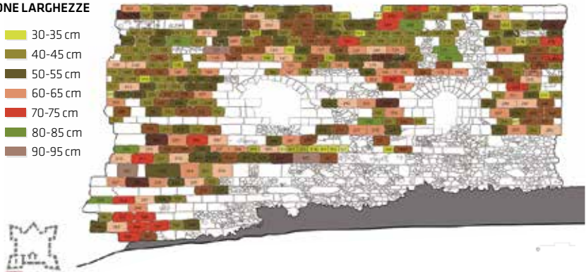
Fig. 2.6 Cagliari, forte di Sant' Ignazio. Analisi del prospetto della casamatta di ponente: Analisi delle tipologie murarie e dei caratteri dimensionali (rilievo D.R. Fiorino e C. Giannattasio, restituzione grafica M. Belfiori).
