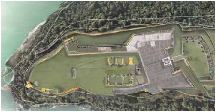
Fig. 4.5 Sovrapposizione del rilievo effettuato nel 1980 (in bianco) con il rilievo topografico e fotogrammetrico eseguito nel Gennaio 2013 (elaborato materico). Le differenze più rilevanti del prodotto più recente con quello precedente sono evidenziate dalle aree in giallo, che mostrano sostanziali traslazioni di volumi che influiscono sulla qualità del progetto di recupero del manufatto.
