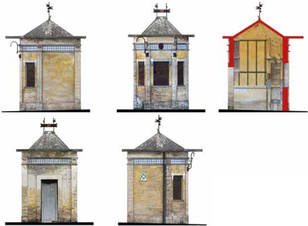
Fig. 9 Rilievo dello stato di fatto: prospetti e sezione del chiosco, (Cecchi, 2014)
