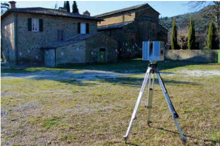
Fig. 3 Le fasi di scansione all'esterno del complesso di Metelliano
