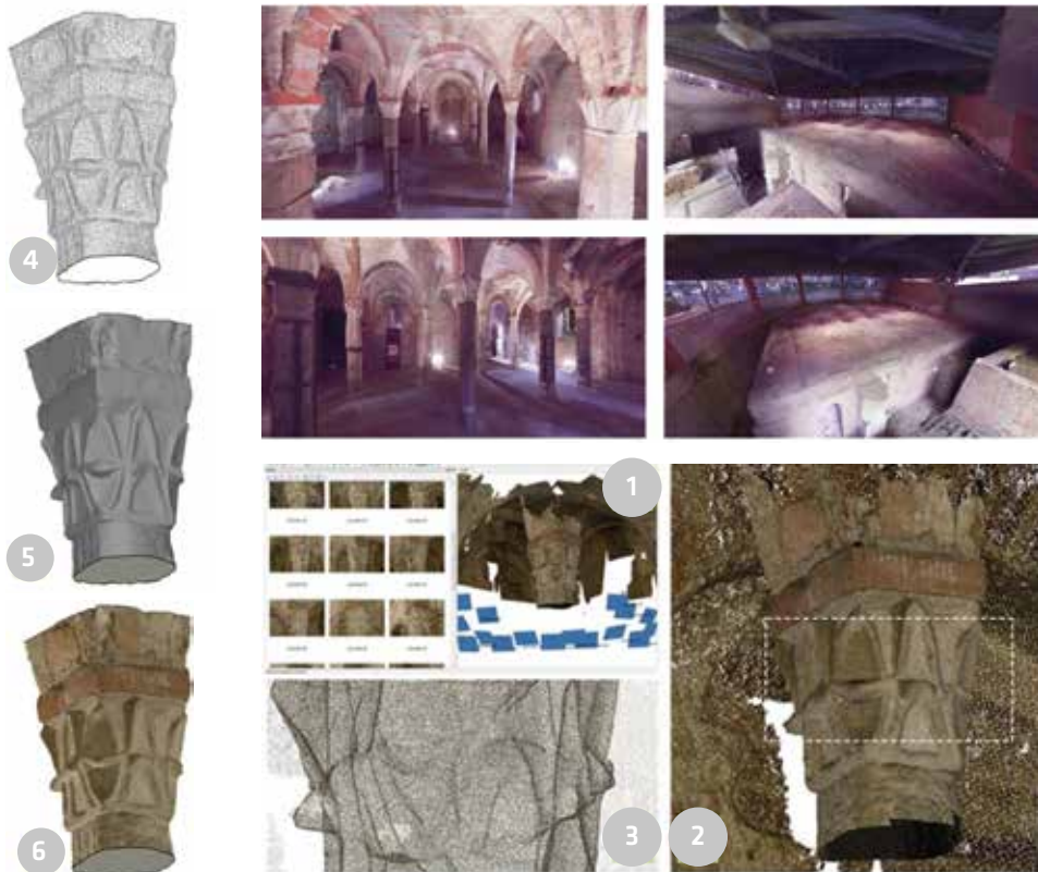
Fig. 2.5 Il rilievo integrato 3D laser scanning e le campagne fotografiche volte alla modellazione image-based
