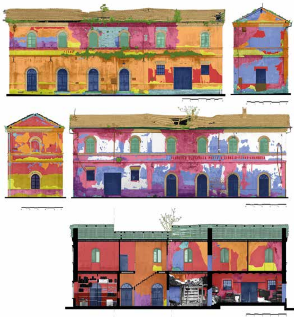
Fig. 10 Rilievo delle forme di degrado: prospetti e sezione della stazione, (Cecchi, 2014)
