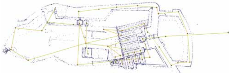
Fig. 4.3 Il prodotto del rilievo topografico in vista planimetrica, con evidenziati in rosso le posizioni di stazione, in giallo il progetto di acquisizione del complesso e in blu i punti acquisiti da ciascuna stazione.
