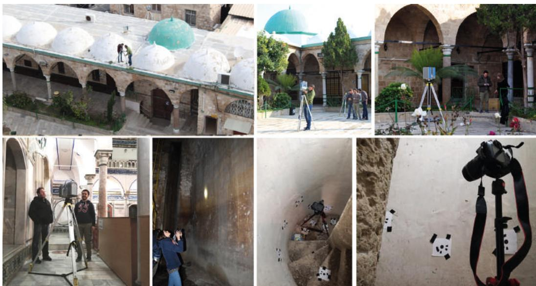
del dato della nuvola di punti) sia di tipo NURBS (dall'elaborazione numerica), integrate con mappature, *texture*, acquisite e generate dall'elaborazione delle immagini<sup>7</sup> provenienti da campagna fotografica *close range* e in quota (sono stati realizzati modelli fotogrammetrici da sequenze fotografiche scattate dal ballatoio della Moschea, dal ballatoio terminale del minareto, dal camminamento perimetrale dell'estradosso del chiostro). (Fig. 3.4)
