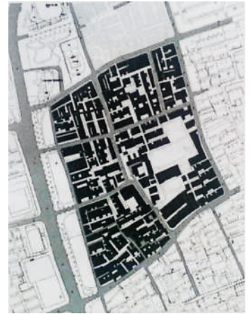
Fig. 13 Progetto finale per il layout del comparto di Luxiang: pur mantenendo in essere la viabilità principale e gli edifici ritenuti di valore storico lungo strada, la distribuzione e la morfologia dei nuovi fabbricati altera quantitativamente e qualitativamente la natura del comparto (tratto da Zhou J. 2012, p. 30)
