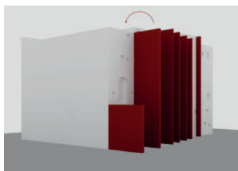
fronte su Lungarno, rialzamento dei setti murari in previsione della nuova facciata
