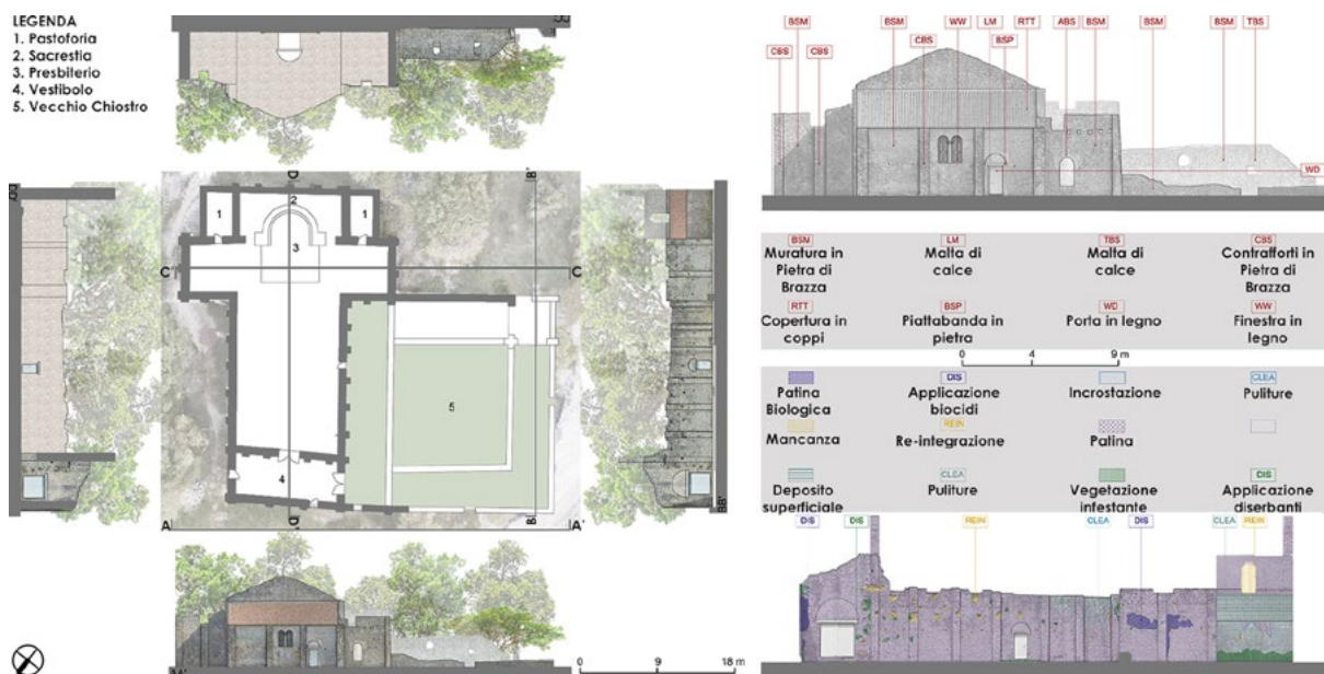
Figura 3. Croazia, Basilica Paleocristiana di Mirine-Fulfinum, rilievo geometrico [a sinistra] e rilievo materico e del degrado [a destra] (elab. Adriana Trematerra, 2024).
