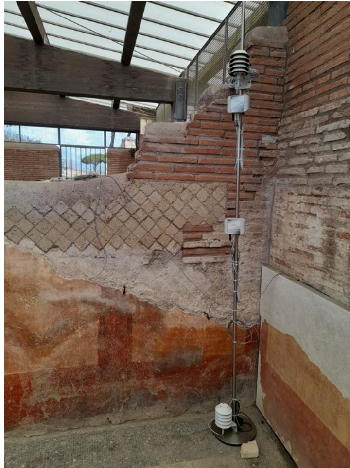
Figura 4. Ostia antica, Insula delle Ierodule, data-logger posizionato nell'ambiente 7 (foto S. Cigognetti, 2023).
