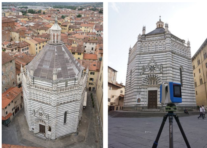
Figura 1. Fase di rilievo laser-scanner del Battistero di San Giovanni in Corte (foto G. Verdiani, 2023).
