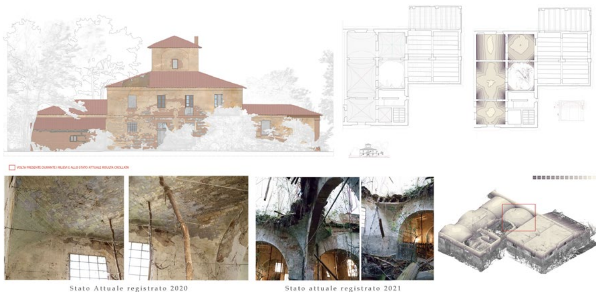
Figura 2. Montepulciano, Leopoldina S. Leopoldo, rilievi materici, analisi del sistema voltato mediante elevation map, documentazione della volta prima e dopo il crollo (elab. G. Angiovini, 2021).
