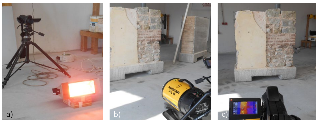
Figura 2. Prove termografiche in modalità attiva: a) lampada IR; b) termoconvettore ad aria; c) acquisizione radiometrica.
