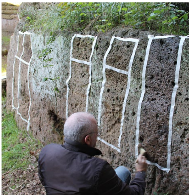
Fig. 3 Cerveteri, Via degli Inferi, l'applicazione dei formulati protettivi sulla parete di una tomba (Foto T. Vagnarelli 2020)
