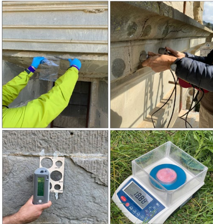
Fig. 3. Cortona, chiesa di Santa Maria delle Grazie al Calcinaio. Esempi di indagini diagnostiche, a) prelievo campioni per indagini minero-petrografiche, b) indagini ultrasoniche e c, d) indagine colorimetrica e di assorbimento acqua con spugna a contatto (T. Salvatici 2023).
