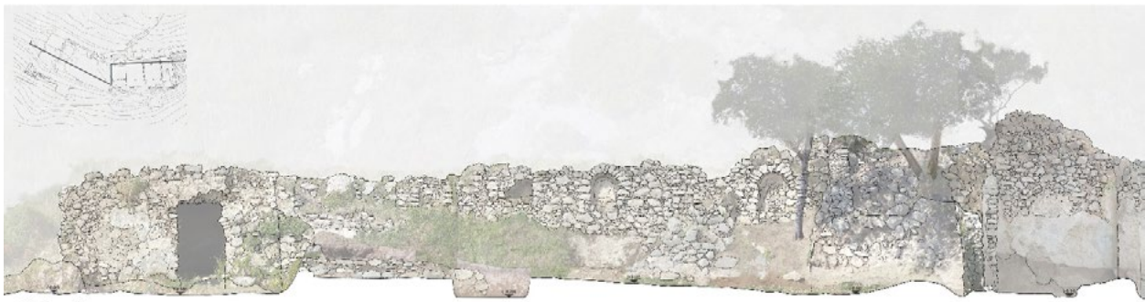
Fig. 3 Crapolla (Massa Lubrense), Abbazia di San Pietro, sezione longitudinale (part.). Caratterizzazione materico-costruttiva del fronte settentrionale (elab. S. Pollone, L. Romano, F. Marulo).
