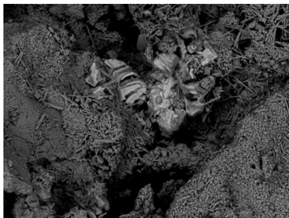
Fig. 7. Torre Zozzoli (TA). Immagine al SEM di un campione di pietra di un blocco del cantonale sinistro del prospetto ovest. I cristalli di Halite ( \text{NaCl} ) si dispongono nelle cavità e nelle porosità aperte. Le cristallizzazioni saline si presentano di tipo idiomorfo (tridimensionale). Riscontrate calciti aciculari in fase di cristallizzazione secondaria (sovrapposti all'halite).
