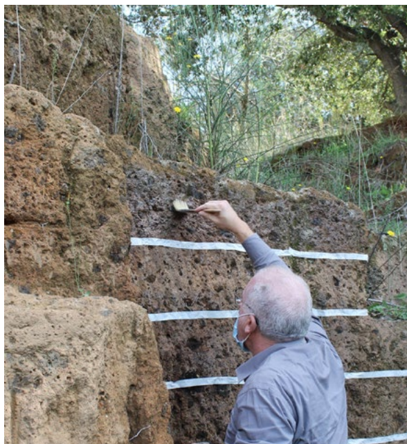
Fig. 4 Cerveteri, Altopiano delle Onde Marine, l'applicazione dei formulati protettivi sulla parete di una cava etrusca (foto T. Vagnarelli 2020)
