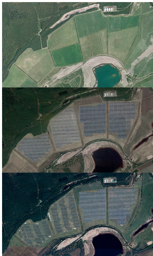
Fig. 8 – Il revamping del Solarpark Finsterwalde. Soglie temporali significative: prima della costruzione dell'impianto (2008), durante la fase operativa (2022) e il diradamento odierno (2025) (foto: Google Earth).
