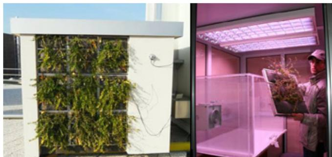
Area Index) il parametro fondamentale per correlare variabili energetiche e ambientali. Infatti la superficie fogliare influenza sia le capacità termiche della parete sia le potenzialità di diluizione di inquinanti dell'aria. Gli scarti di produzione di feltrini sottosedia sminuzzati, all'interno del substrato, hanno consentito un migliore sviluppo dell'apparato aereo, aumentando il numero di foglie e la superficie fogliare (Bianco et al., 2012);
