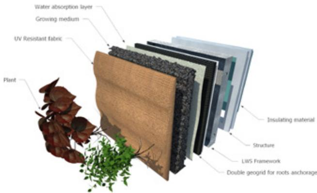
– strato di protezione: realizzato attraverso l’abbinamento di un feltro in PE e viscosa, in grado di ridurre lo spessore e il peso della parete verde.
