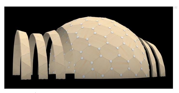
zioni erano connesse alle macchine CNC utilizzate per il taglio laser dei pannelli, ai limiti di trasporto, dal momento che tutti i componenti dovevano essere spediti in scatole di dimensioni prestabilite, dalla necessità di assemblare il padiglione in un solo giorno, e l'uso minimo di qualsiasi strumento elettrico.
