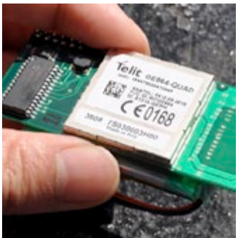
02 | Il dispositivo tag per la geolocalizzazione, progettato e prodotto specificatamente per il progetto Trash Track insieme alla ditta Qualcomm The geolocating tag, designed and produced with Qualcomm specifically for the Trash Track project
