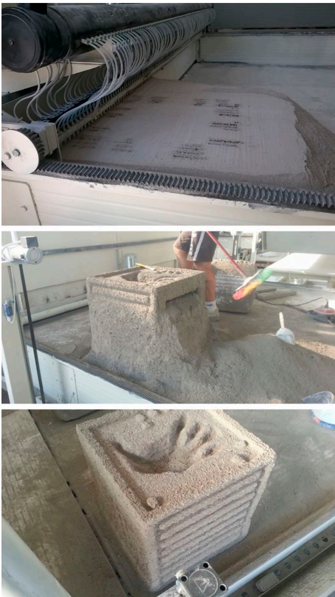
04 | Le fasi della prototipazione con stampante additiva 3D in sabbia riciclata: stampa (a), rimozione sabbia non legata (b), prototipo pronto per le rifiniture manuali (c), foto del GdL di AIP
