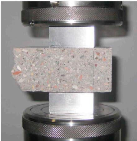
03 | Risultati delle prove sperimentali su due campioni di conglomerato con sabbia riciclata prodotti con stampante 3D, Laboratorio CertiMaC Results of the experimental tests on two samples of concrete with recycled sand produced with 3D printer, CertiMaC Laboratory
